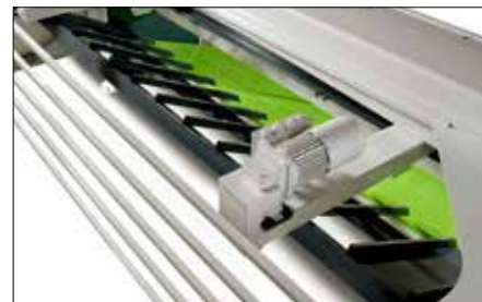
Hochhalter unten für Transport zur Vorderseite mit Steuerung der Bewegung durch CutLink.
