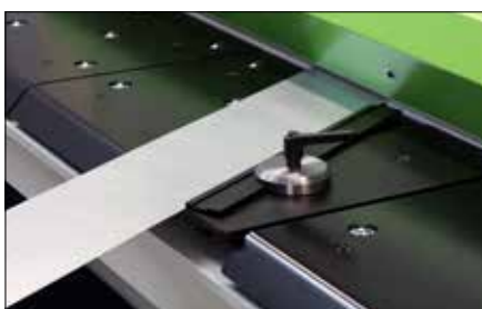
EVO DUO bietet um 360° verstellbare Winkelanschläge mit deutlicher Gradskala für Schrägschnitte (Option).
