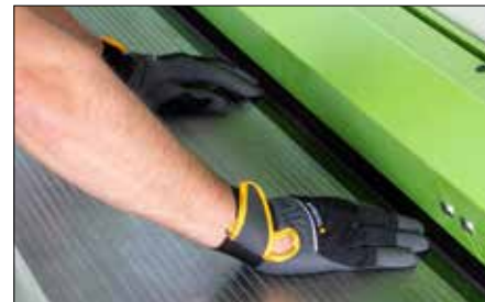
Die Positionierung des Niederhalters in lediglich 32 mm Entfernung von der Schnittkante bedeutet minimalen Verschleiß.
