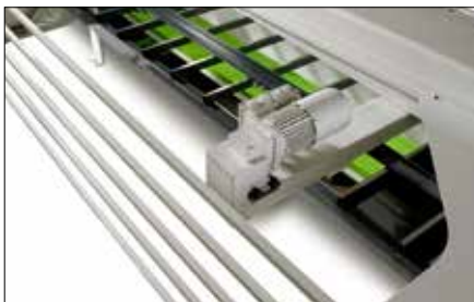
Niederhalter oben, ausreichender Abstand zwischen den Kugelgewindetrieben, um ein 1250 mm breites Blech durchzuziehen (nicht RAPIDO 13).
