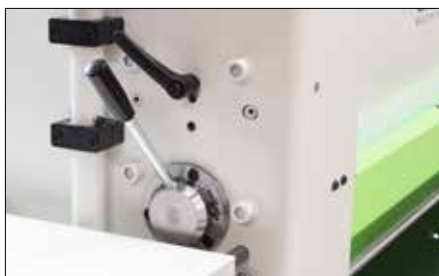
Einfache und deutliche Schnittspalteinrichtung für unterschiedliche Blechstärken.
