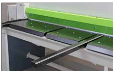
Die strategisch platzierten Auflagearme erleichtern das Handling. Mit T-Nut-Schienen und Kippstopp landet der abgetrennte Zuschnitt an der Vorderseite der Tafelschere und der Abschnitt in der Maschine.
