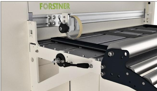
Die neue SLIT Serie verfügt über zwei Panelhalterungen, die dem Kunden erlauben, jederzeit die Bedienseite anzupassen. Diese Kombination mit dem neuen Tischkonzept, gibt Ihnen maximale Flexibilität für die Zukunft.
