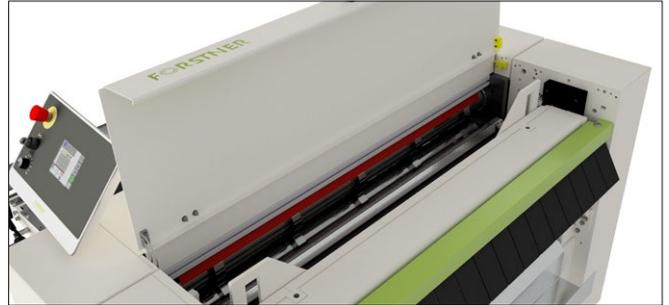
Um Ihnen die Einstellung der Spaltmesser zu vereinfachen, haben wir eine LED Spaltmesserbeleuchtung eingebaut. Diese verleiht der Anlage ein optisches Highlight und trägt zur sicheren und schnellen Einstellung der Spaltmesser bei.
