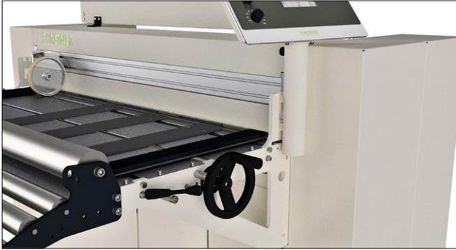
Die Einstellung der Tischführung befindet sich bei der neuen SLIT Serie nun auf beiden Seiten des Tisches. Das Handrad kann auf beiden Seiten angebracht werden, da die Arretierung der Führung nun über ein neuartiges Konzept erfolgt. Weiteres wurde die Spindel zur Führungseinstellung optimiert, Sie erreichen nun mit einer Umdrehung den doppelten Vorschub der Bewegung, das macht den Blechwechsel noch effizienter machen.
